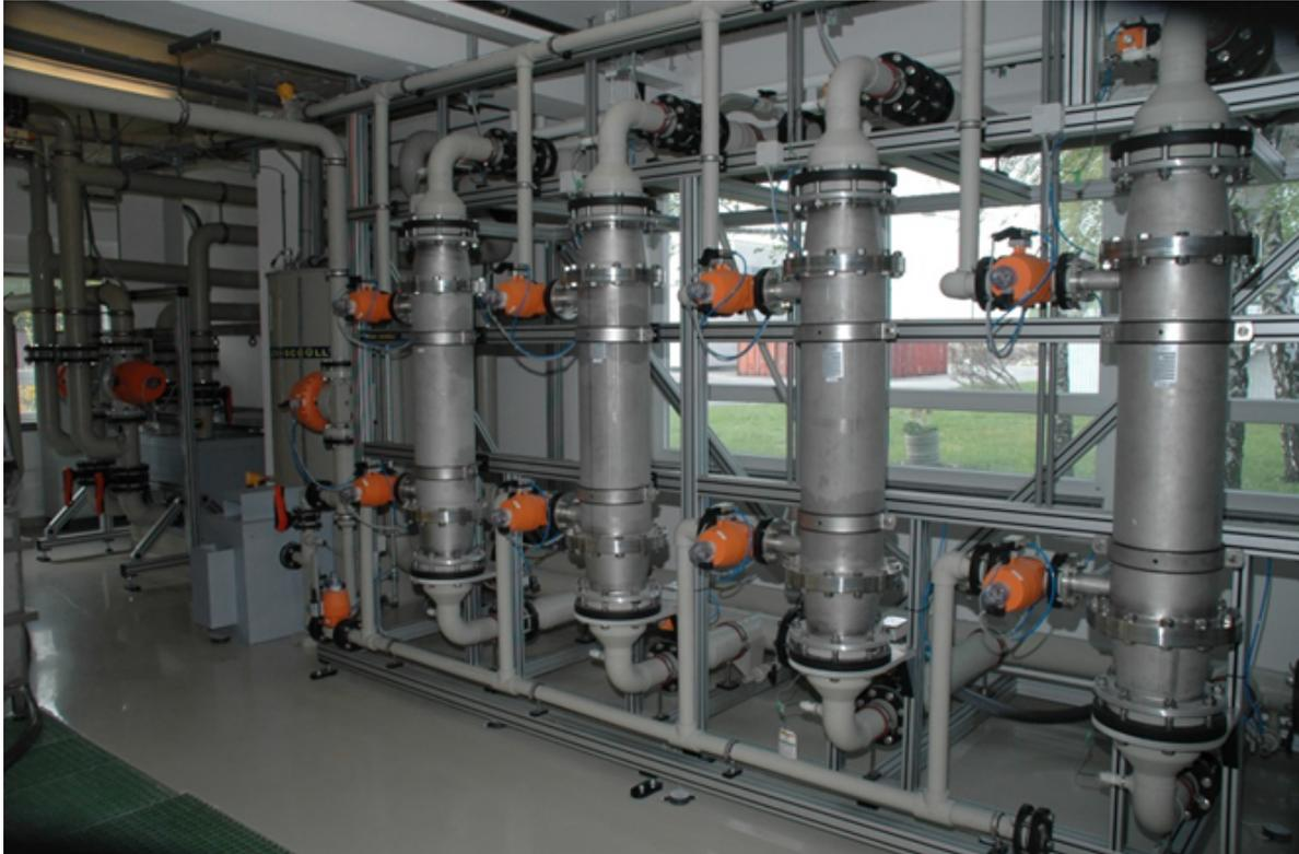
Die Betriebserfahrung hat gezeigt, dass durch diese Anlage der Einsatz von Chemikalien für die Fällung drastisch reduziert werden konnte, da in der Regel bei der Abwasseraufbereitung keine vorbereitende chemische Fällung mehr notwendig ist, und auf diese Weise bei der Abwasserreinigung die Menge an entstehenden radioaktiven Abfällen um den Faktor 20 verringert werden konnte.
